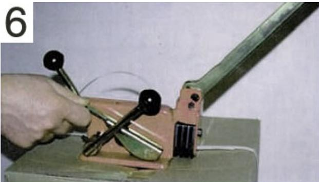
Mediante la palanca del sistema cortador, seccionaremos el fleje. Levantando ligeramente la parte delantera de la máquina, liberaremos el precinto y podremos retirar la flejadora lateralmente.
