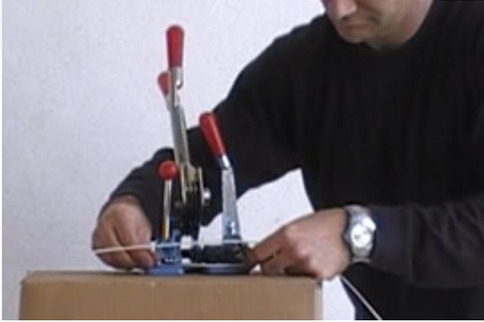
Situaremos la parte final del fleje bajo la placa de sujeción de la flejadora.
