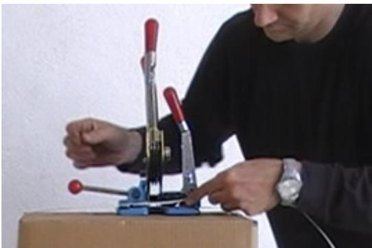
El otro extremo del fleje lo deslizaremos dentro de la ranura de la rueda trasera.
