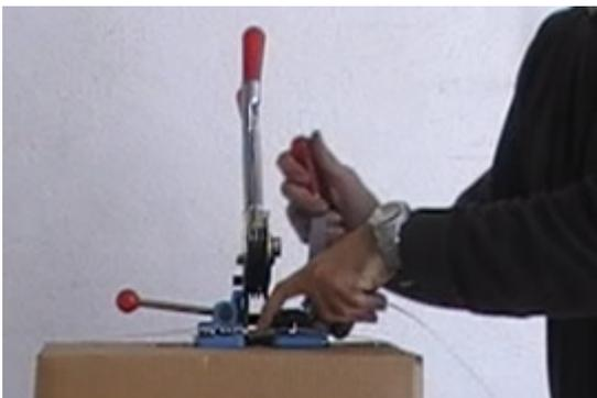
Accionaremos la palanca de vaivén hasta tensar el fleje.
