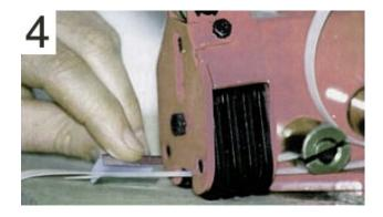
Introduciremos el precinto en el interior de la boca de cierre, sujetando el fleje. Después, volveremos a tensar el fleje como hicimos en el paso 3. Hasta el punto que estimemos adecuado.
