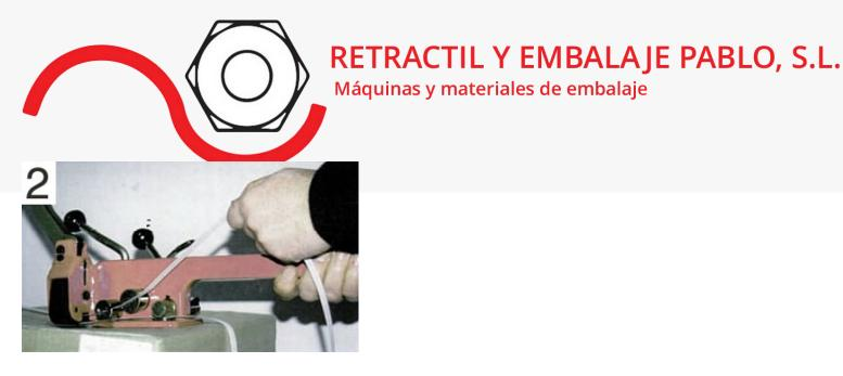
Después colocaremos el otro extremo del fleje por encima del que hemos situado anteriormente en el paso 1, pasándolo por debajo de la boca de cierre y por las ranuras del casquillo cortador y del eje tensor.
