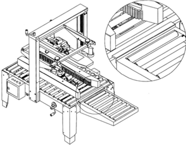
*Colocación de la extensión de mesa de rodillos. Es un proceso muy sencillo, solo es necesario encajar el complemento en las ranuras situadas en los extremos de la precintadora.*
