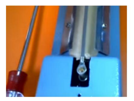
Retiramos la cinta de teflón dejando la resistencia al descubierto. Podremos retirar también la resistencia desenganchándola de su barra de soporte.
