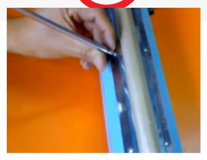
Aflojamos los tornillos de la sujección del teflón. Ni siquiera es necesario retirar la sujeción por completo.
