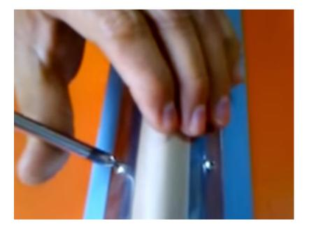
Apretando los tornillos de la sujeción terminaremos la operación. Es importante no dejar arrugas en la cinta de teflón.
