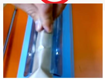
Siguiendo el camino inverso al recorrido, colocaremos la resistencia y el teflón nuevos. Podemos ayudarnos de un destornillador para enganchar la resistencia más fácilmente.
